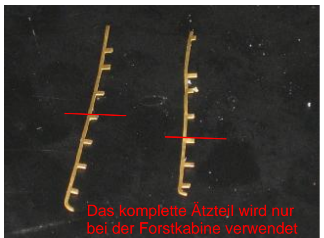
bei der 5. bzw. 4. Strebe abschneiden
