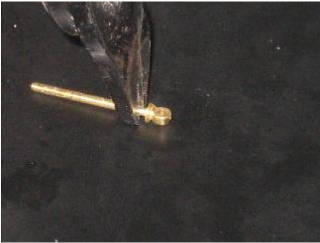
abgezwickte Öse in Kupferrohr mit Sekundenkleber einkleben
