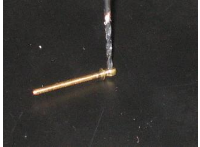
mit 1,1mm Bohrer aufbohren
