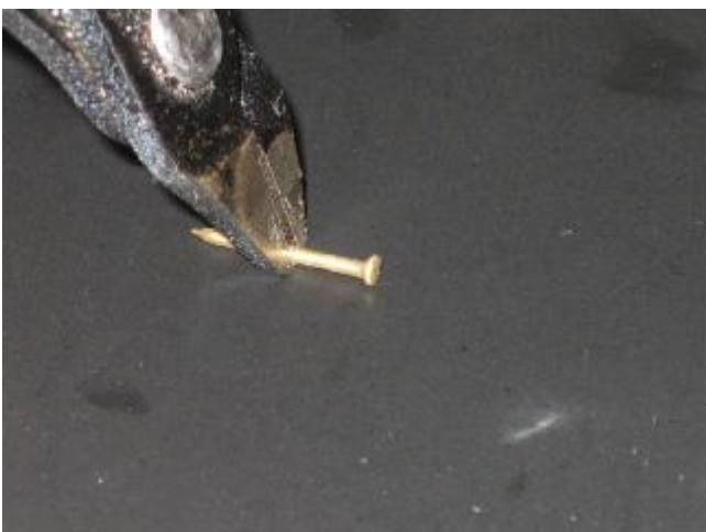
1mm Bolzen bei 4,50mm abzwicken
